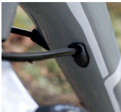
Vnitřní vedení bowdenů řazení spodní trubkou – řešení používané ve vyšších cenových hladinách
