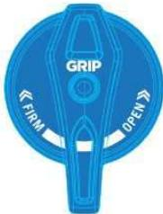
Dvoupoziční nastavení s mikromezipolohami s páčkou na korunce vidlice umožnuje jednoduché nastavení tlumení komprese za jízdy. Tlumení komprese ovlivňuje rychlosť, se kterou se ponořuje vidlice do zdvihu a její citlivost. V poloze OPEN je vidlice zcela otevřená, v poloze FIRM je naopak útlum komprese nejvyšší a citlivost nejnižší. Mezi těmito dvěma polohami se nacházejí mikropolohy pro možnost individuálního nastavení dle Vašich konkrétních požadavků.
