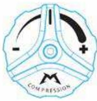
Otáčejte ovladačem tlumení komprese ve směru hodinových ručiček do koncové + polohy. Poté otáčejte proti směru hodinových ručiček o 4 kliknutí zpět (pro výchozí nastavení). Tlumení komprese ovlivňuje rychlosť, se kterou se ponořuje vidlice do zdvihu a její citlivost. Nastavení tlumení nízkorychlostní komprese je užitečné pro ovlivnění funkce vidlice při přejezdu malých nerovností, pohupování při šlapání hmotnosti jezdce a dalších nízkorychlostních impulsech.
