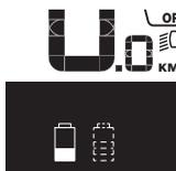
Če se na električnem kolesu z dvema akumulatorskima baterijama polnita obe akumulatorski bateriji, potem je na zaslonu prikazan napredek polnjenja obeh akumulatorskih baterij (na sliki se polni leva akumulatorska baterija). Po utripajočem prikazu na akumulatorski
