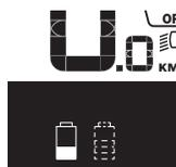
Pokud se u systému eBike se dvěma nasazenými akumulátory na jízdním kole nabíjejí oba akumulátory, na displeji se zobrazuje postup nabíjení obou akumulátorů (na obrázku se právě nabíjí levý akumulátor). To, který z obou akumulátorů se právě nabíjí, poznáte podle bližšího ukazatele na akumulátoru.
